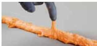
Lijm trekt draden bij aanraking na ± 1 min.: optimale kleefkracht
