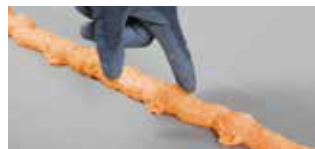
Velvorming, lijm voelt droog aan: te laat, opnieuw lijm aanbrengen
